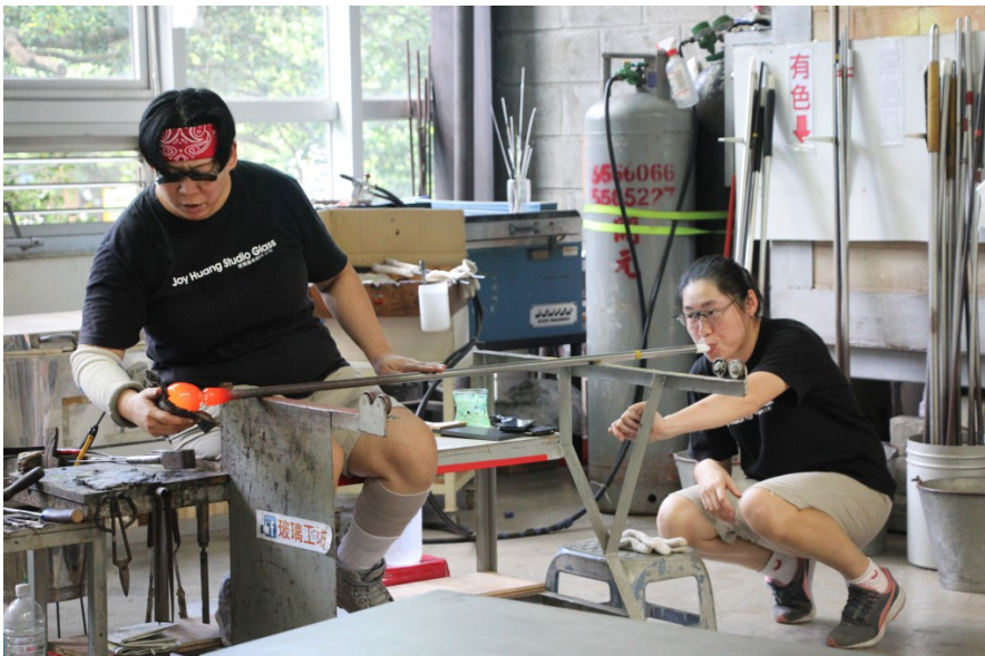
黃瓊儀（左）一邊用沾了水的報紙塑形，助手一邊從鐵管將氣吹進玻璃中。（照片來源／范晨星攝）
