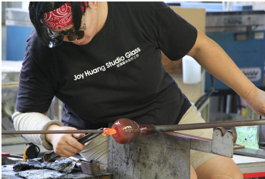
黃瓊儀將吹到足夠大小的玻璃球接到另一支鐵管上。(照片來源／范晨星攝)
