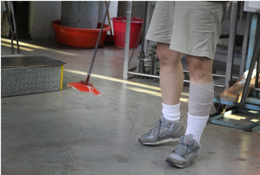
黃瓊儀揮動鐵管，為剛離開窯爐的圓形玻璃盤塑造出荷葉邊。(照片來源/范晨星攝)
