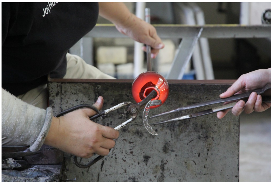
加熱之後玻璃呈柔軟狀態，黃瓊儀用特製的鐵剪在原先鐵管接合處剪出開口。(照片來源／范晨星攝)
