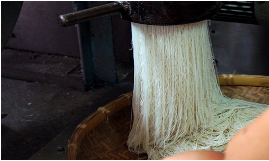
放入米粉車的米片經過「銅穿」（以細孔金屬模具輾壓米片）產生條狀的米粉。（照片來源／范瑀真攝）
