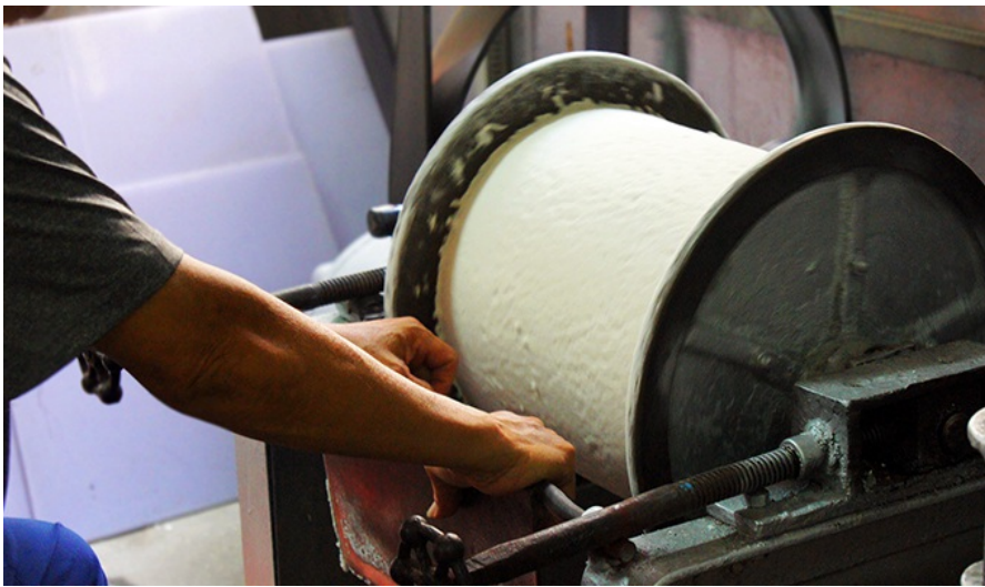
以「輾掄」壓實米糰、擠出多餘空氣，稱為「掄米片」。(照片來源/范瑀真攝)
