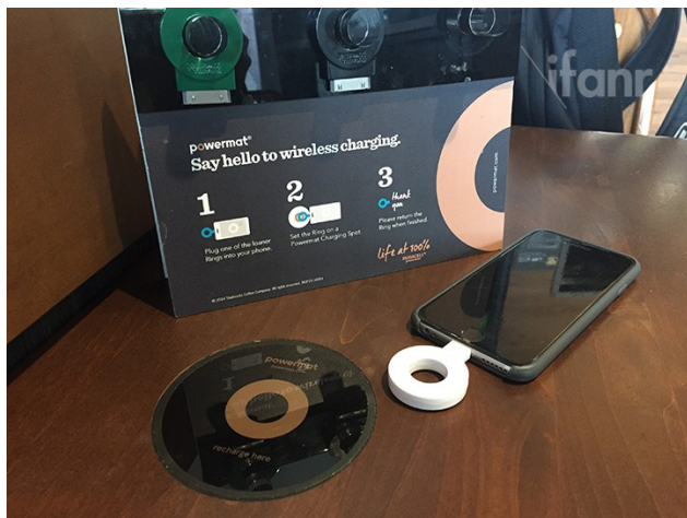
將充電圓環放置在圖中充電板的中心位置即可充電。(圖片來源/數位時代)
