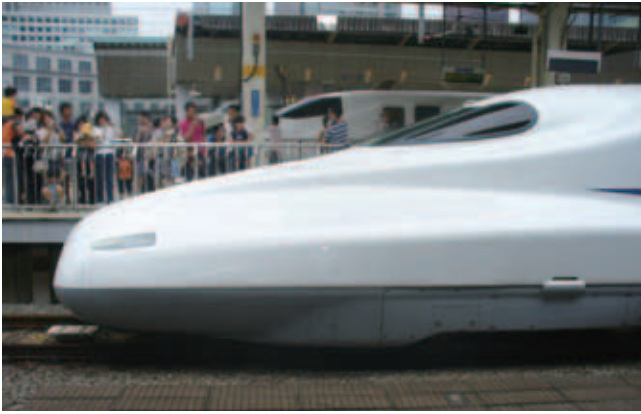
日本新幹線 N700 系列車「氣動雙翼」的獨特空氣動力造型車鼻，是應用基因演算法運算結果。(維基)
