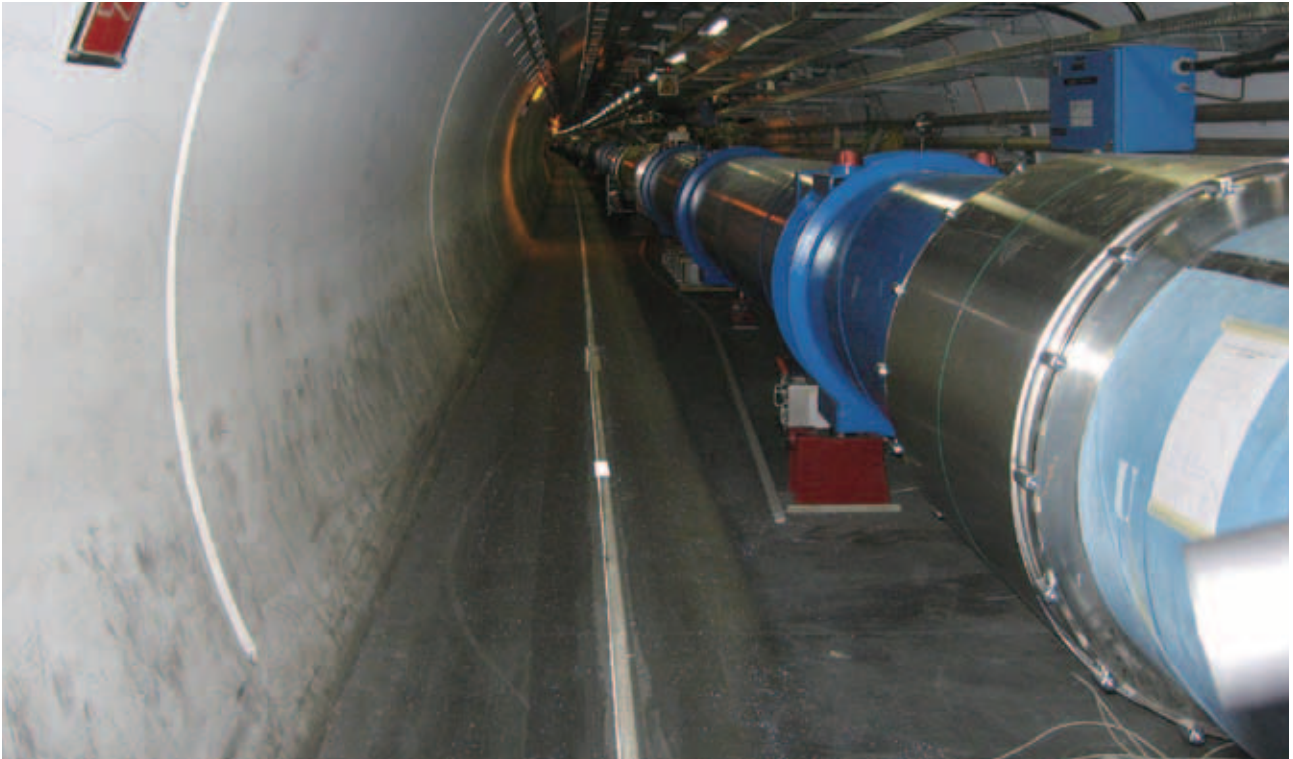
LHC 的主要元件偶極超導磁鐵組裝照片，磁鐵每節長 14.2 公尺，總共用了 1,232 節磁鐵。(維基)
