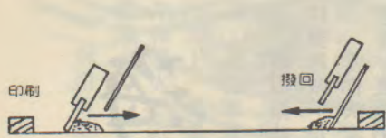
●機器印刷時刮刀和撥回刮刀的動作
