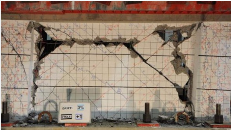
C50W6的裂縫發展呈現口字型。( 圖片來源 / 台灣省土木技師公會技師報 )
