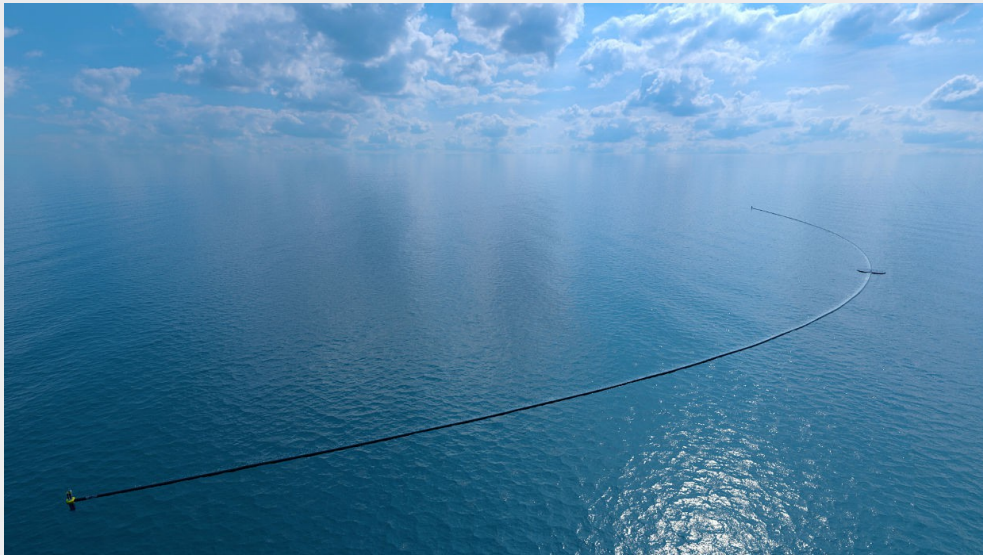
全長600公尺的海洋清潔系統001。(圖片來源 / THE OCEAN CLEANUP )
