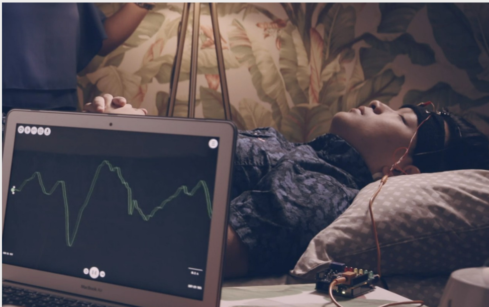
實驗中用以確認受測者進入慢波睡眠階段的腦波測量儀器。(圖片來源 國立交通大學機構典藏系統版權所有 Produced by IR@NCTU
