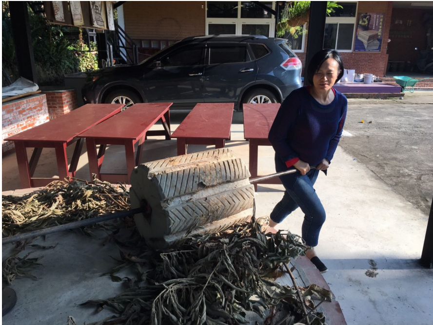
▲張秀雲示範用石輪輾壓植物，將植物碾碎後方能進行後續製紙步驟。(攝影/簡梵軒)
