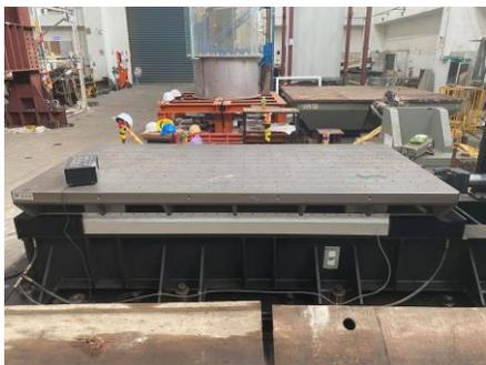
圖五、土木結構大樓試驗場域與振動台
