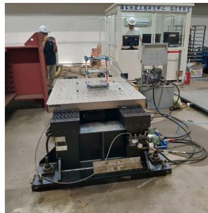
圖九、學生利用油壓振動台 B 進行試驗
