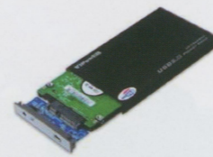
●圖14 2.5吋硬碟外接盒，目前有2.5吋與3.5吋兩種，USB介面，後者都需要額外電源。硬碟能取出使用，這跟圖13最大的不同
