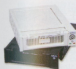
●圖15 硬碟抽取盒，裝在桌機中光碟機部分的安裝槽，支援熱拔插功能，通常是3.5吋SATA、IDE或SCSI硬碟
