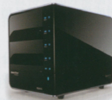
●圖18 網路儲存設備NAS（Network Access Server），在建構與使用需要MIS專業規劃，不適合隨身攜帶，可以遠端操作，利用網路儲存到其他非診所區域的電腦
