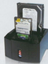
●圖16 抽拔式硬碟外接盒，USB介面，除了可以插2.5吋與3.5吋兩種硬碟外，隨身碟、CF卡和SD卡也可
