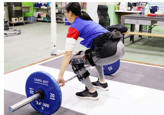
精準舉重平台能即時測量施力、作用力等參數（左圖）；裝置在大腿的骨骼肌器人能協助舉重選手維持大腿兩側肌肉平衡，避免運動傷害（右圖）
