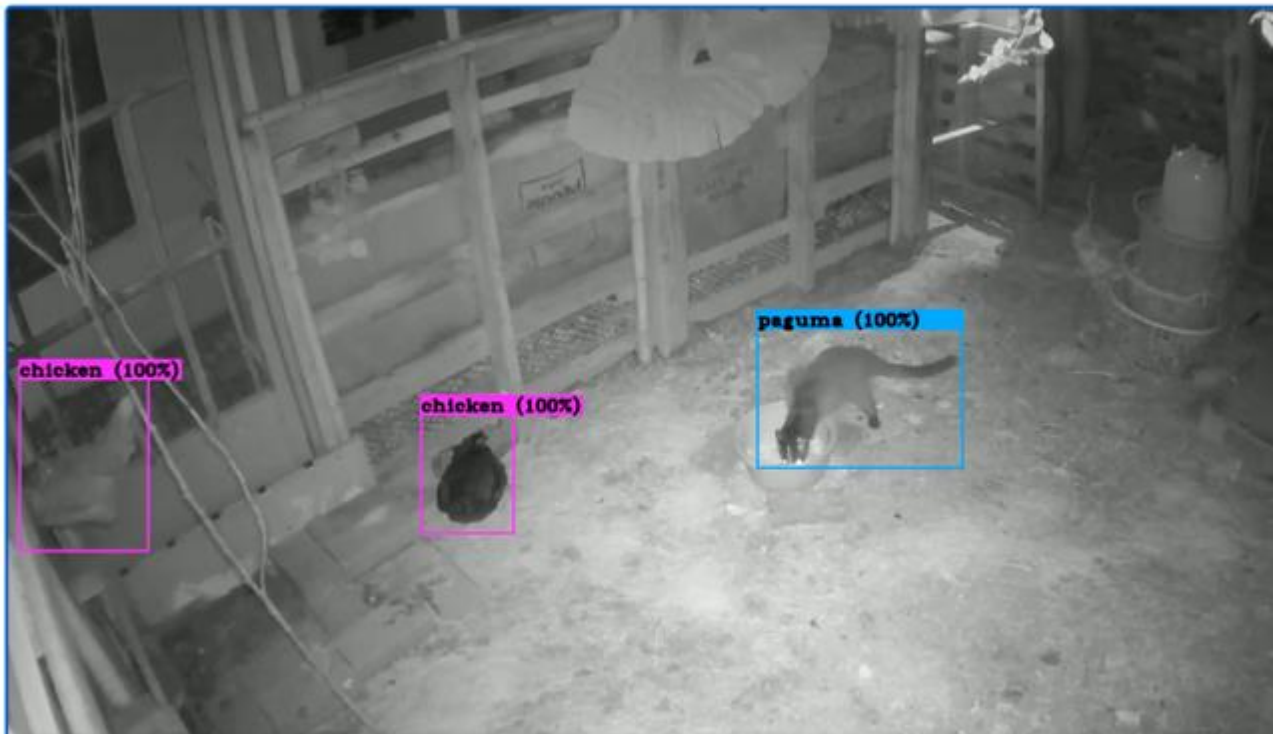
圖 3 資工 IoTtalk 團隊所開發的雞舍即時監控與雞隻行為辨識系統。此影像呈現保溫雞舍即時監控影像，生物辨識系統會將偵測到的「雞」與「非雞生物」予以框出標記。影像最右邊的藍框為「白鼻心」，左邊兩個紅框為「雞」。
