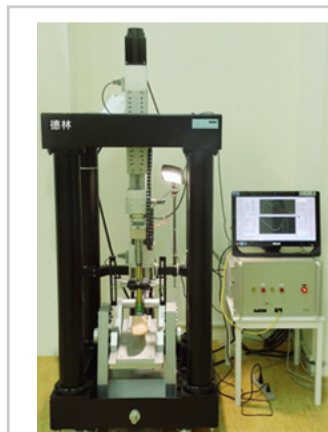
ISO22675足踝義肢疲勞破壞檢測設備
