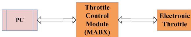
Fig. 22. System identification of ET using MABX.
