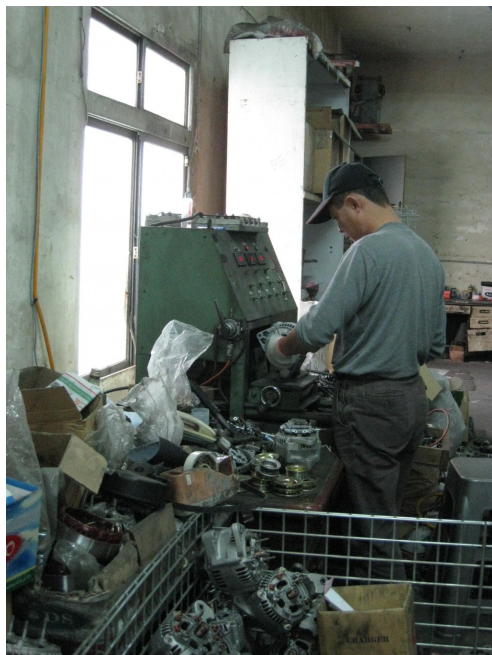
操作著機台進行電流測試，如果通過測試，成品就可以包裝出貨，做為產品監控的最後一個環節格外地馬虎不得。(攝影/張芳瑜)
