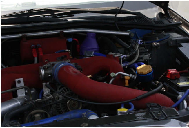
這大概就是土砲的極致吧。不過還知道在引擎室加裝拉桿強化剛性，拍拍手。 (攝影/蔡少安)
