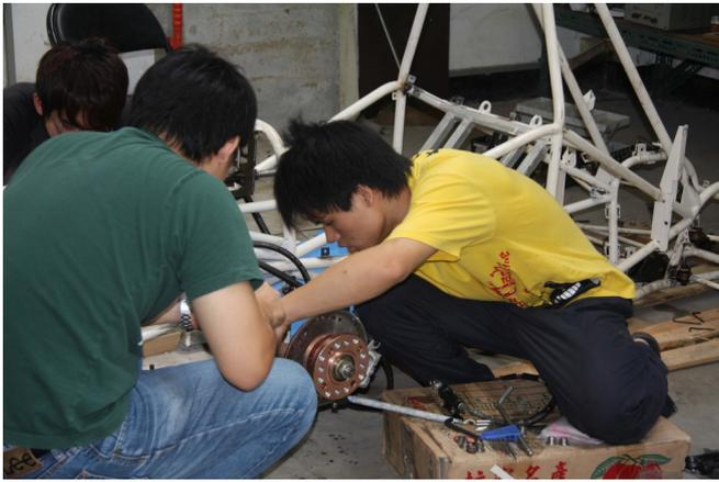
輪殼有傳動軸連接引擎，輪殼和輪胎組合，連帶帶動輪胎旋轉。(攝影/蔡少安)
