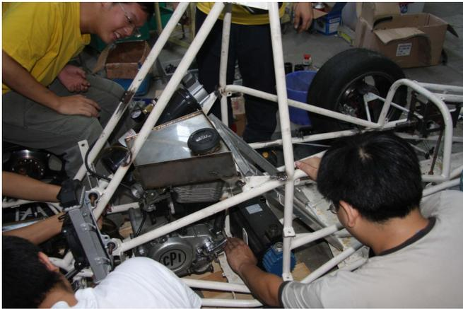
引擎上方是油箱，油箱左邊的黑瓶子提供變速箱換檔的動力。
