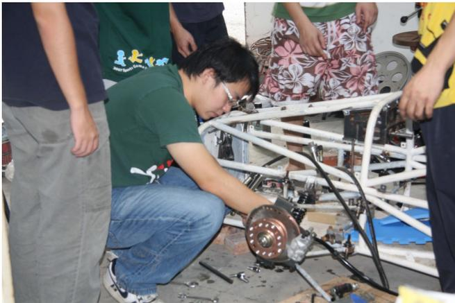
輪殼透過懸吊系統和車體連接。這台車使用的是賽車上最常見的雙A臂懸吊，上下各一支懸臂，造型就像英文字母A而得名。(攝影/蔡少安)
