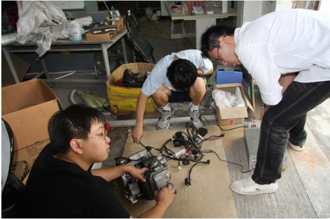
上圖是引擎本體和電系，旁邊的一團電線有兩個接頭，起自電池最終也回到電池，分支出的電線連接車上所有需要供電的設備，形成完整的並聯迴路。（攝影／蔡少安）
