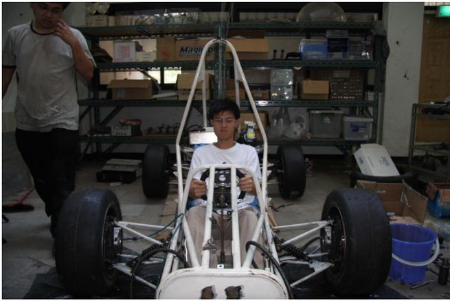
穿過車手兩腿中間的金屬桿是轉向機的一部份，和方向盤的齒輪連接，金屬桿兩端都是直齒圓柱，駕駛座地板端的直齒圓柱和一根有齒條的棒子上成垂直相連，齒條棒又和輪殼相連。轉動方向盤時，齒條棒會被帶動而往左或往右移動，推動輪殼左右轉動，這就是轉彎的原理。（攝影／蔡少安）
