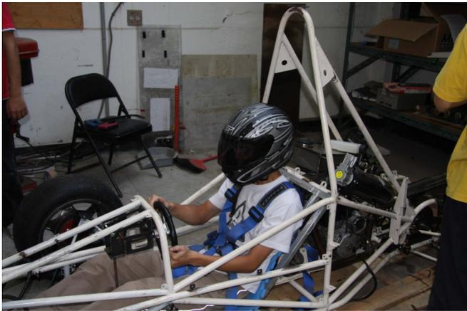
賽車所使用的安全帶為五點式安全帶。賽車運動裡車手必須對抗G力（側向加速力），發生意外時也必須確保車手安全，因此將車手確實固定在座位上是很重要的。在車手肚子前有個安全帶接點機構，只要輕輕一扳，安全帶就會解鎖。（攝影／蔡少安）
