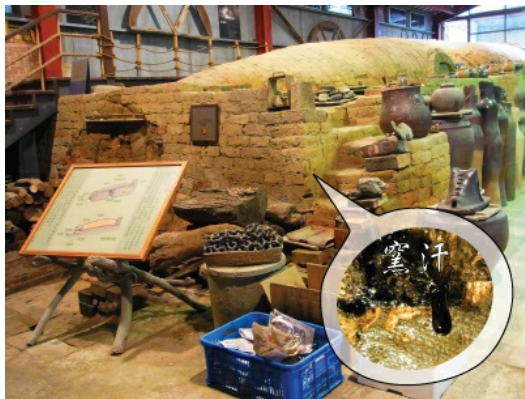
竹南蛇窯的外觀，內容量可燒製數百件作品（約20公尺長）。
