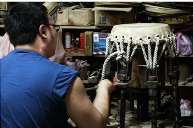
乾燥的牛皮用機器拉開，將鼓面撐開至緊繃，打擊的聲音才能高亢有力。
