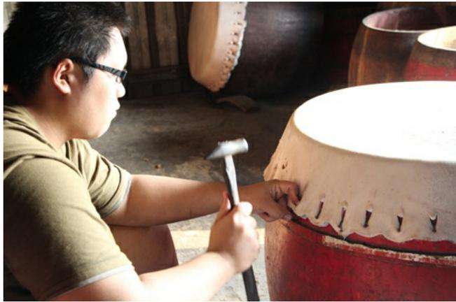
用釘子固定住剛打完洞的牛皮，撐開牛皮。（照片來源／黃莉 攝）
