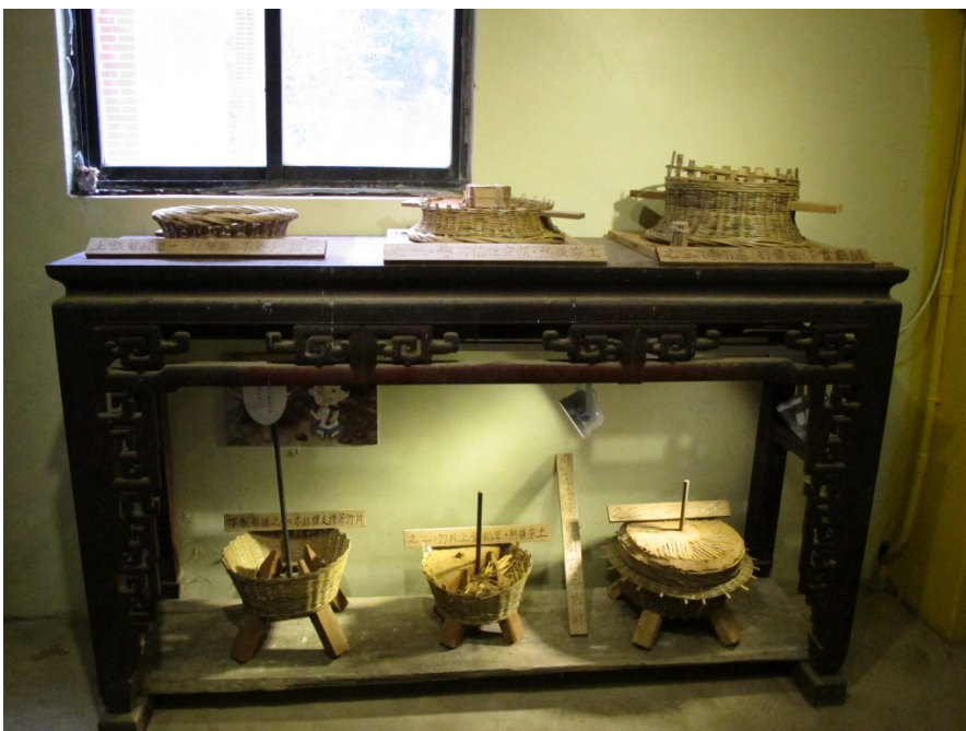
阿華作出六個精緻的土礱分解道具展示在工作室裡，小巧精緻的模型非常詳盡地解釋土礱的原理。(照片來源/李若甄攝)
