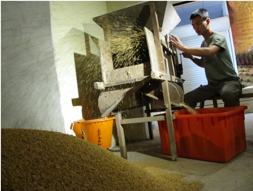
經由土礱碾完的穀殼和糙米之後，再利用鼓風車將比重不同的穀殼與糙米分離。(照片來源/李若甄攝)
