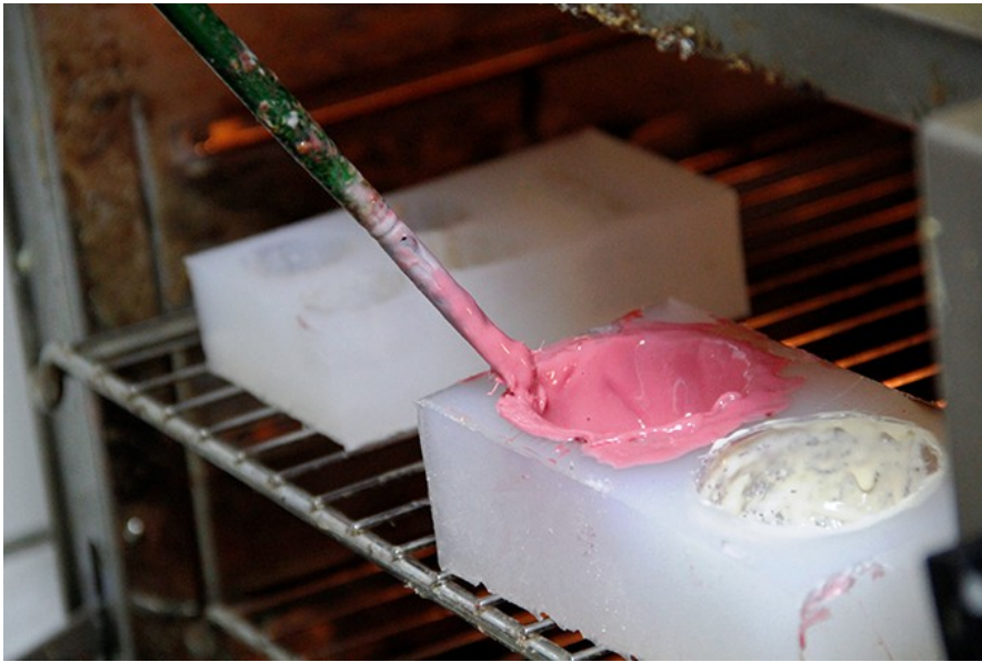
將調色過的樹脂倒入模具，放進烤箱加溫。 在達到理想的硬度與顏色之前，需要反覆中斷烤箱並添加樹脂。（照片來源／簡品心攝）
