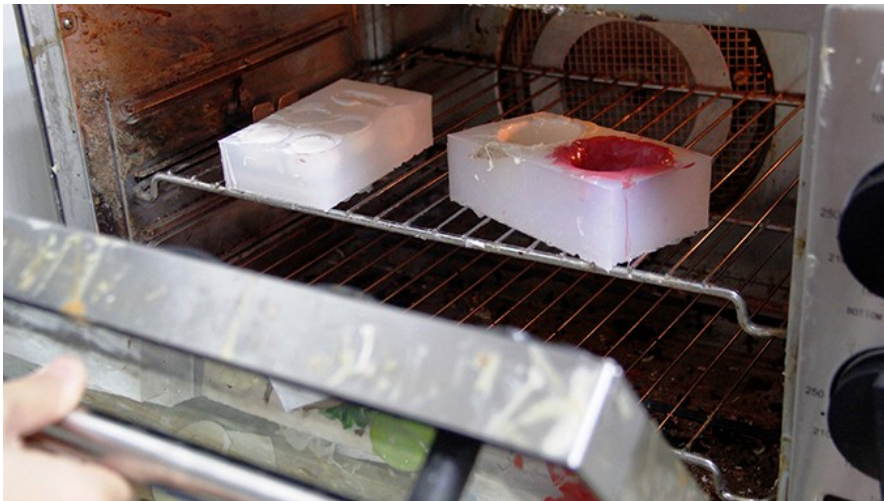
烤箱溫度也是一門學問。溫度太高時模型容易燒焦，太低則無法硬化。（照片來源／簡品心攝）
