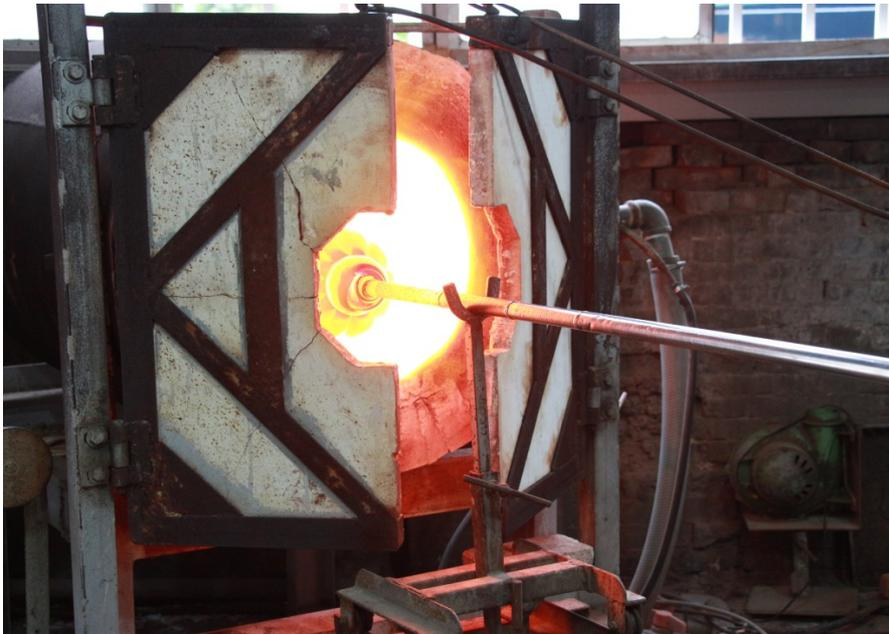
玻璃一接觸空氣就會變硬，因此必須時常放進熔爐加熱。電熔爐裡的溫度高達一千兩百度，能將玻璃極速加熱軟化，經過融熔後，師傅才能繼續雕刻。(照片來源/劉敏慈攝)
