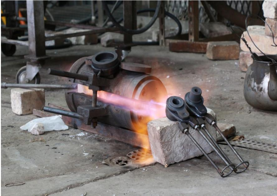
製作玻璃的模具會先在地上用高溫火焰加熱，加熱後的模具溫度高達攝氏四百度，如此一來，能使之後置入的玻璃快速塑型。（照片來源／劉敏慈攝）
