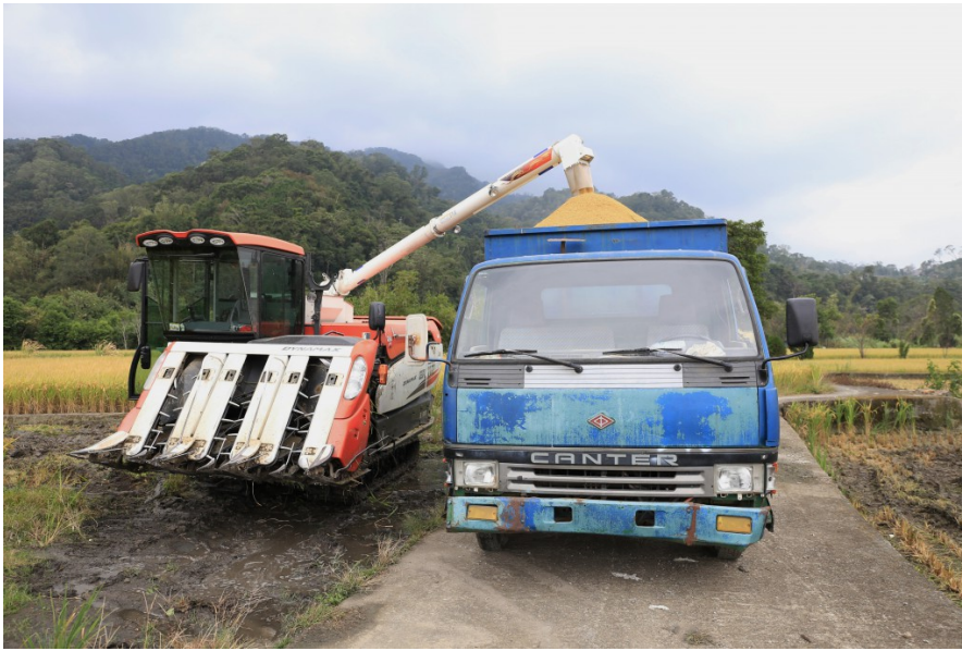
當收割機裝滿稻米後，會將稻米吐出裝進農用大貨車中。而從土地的泥濘可看出當天的土壤濕氣稍高，若是遇到下雨天則不能收割，收割機會因為土地太軟，下陷、傾斜導致危險。（照片來源／鄭青青攝）
