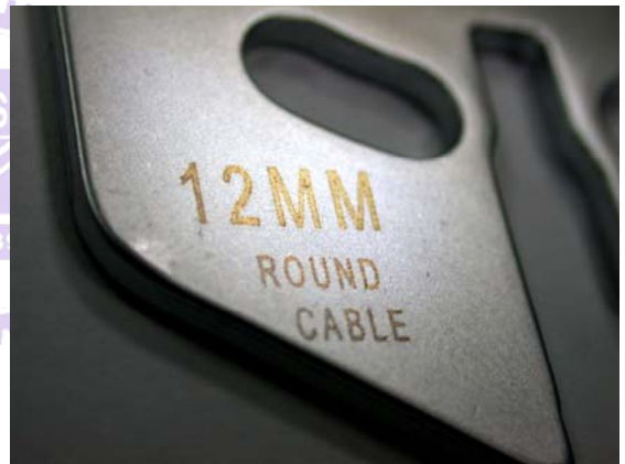
圖 4.6 凹凸腔雷射加工(a)汽車連桿-厚烤漆 (b)鋼材之手工具
