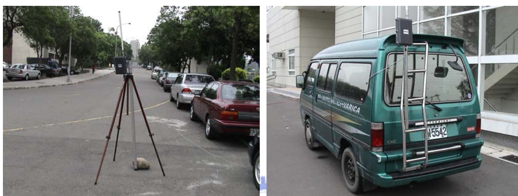
(a)利用腳架搭設臨時固定點 (b)可穩固於車外安裝MANET設備的移動點
