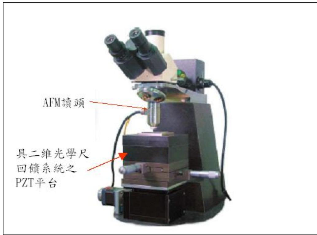
圖 4.5 具二維光學尺回饋系統載物平台的原子顯微鏡
