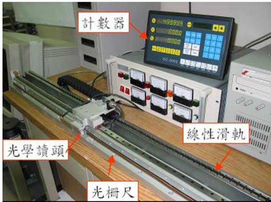
圖 4.1 反射尺應用於線性滑軌的定位控制，並用計數器計數位移。
