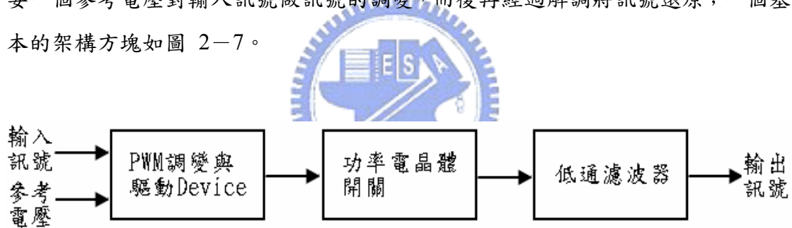
圖 2-7. D 類放大器的基本架構
