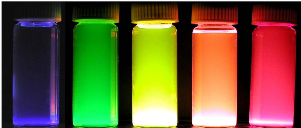
圖 4-4 不同光色量子點於 336 nm UV 光照射下所表現出的螢光
