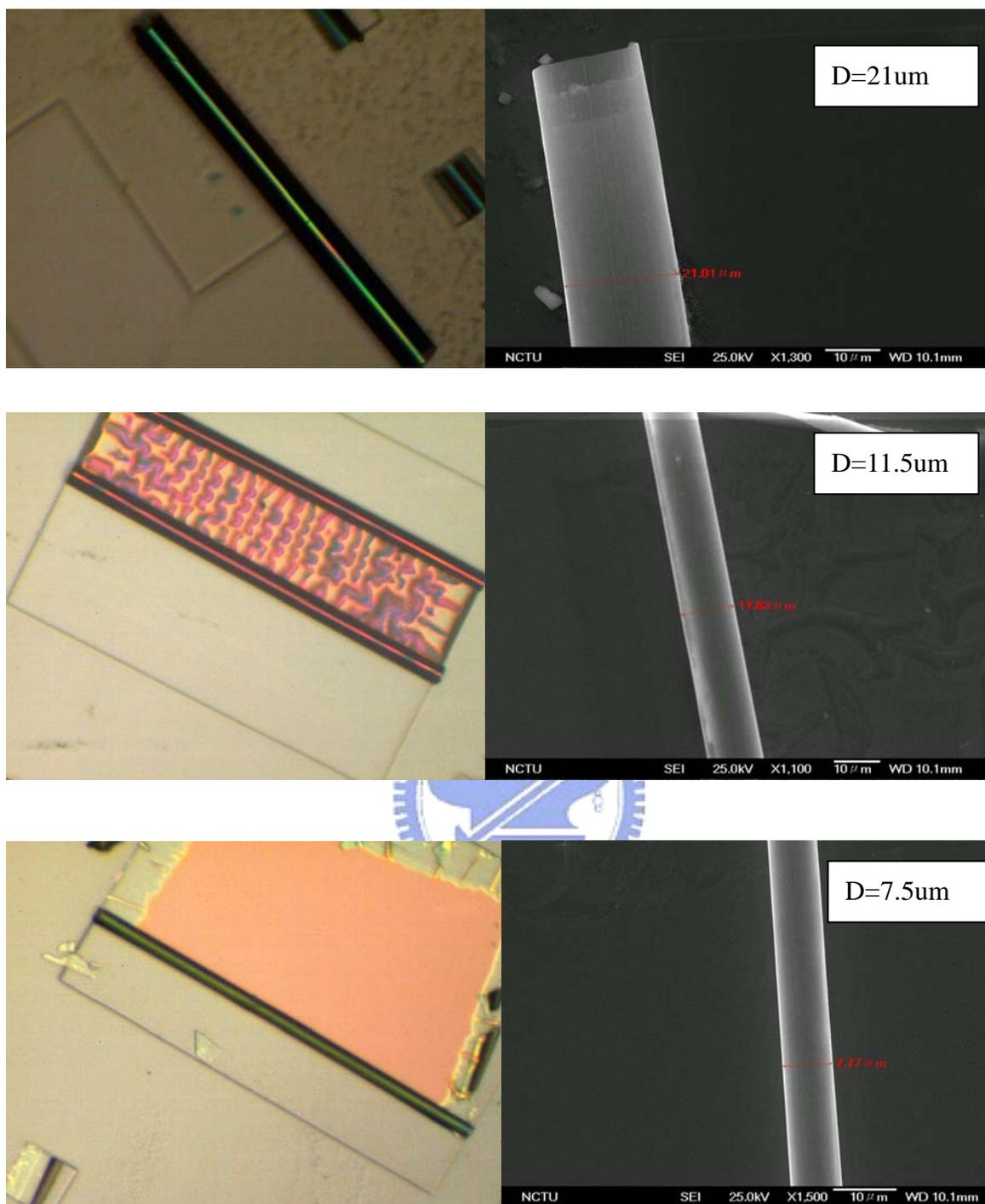
圖 4-3-2 磊晶調變管徑之微米管影像及 SEM
