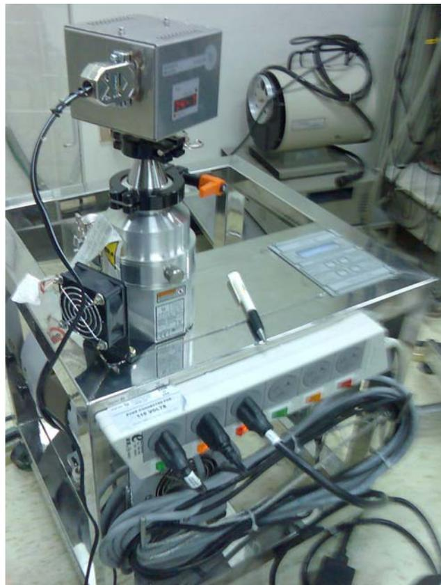
圖 5-2 Scroll 幫浦 及 turbo 幫浦系統
