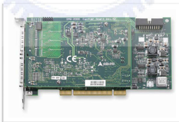
圖 2.13 DAQ-2213 資料擷取卡外觀圖。
