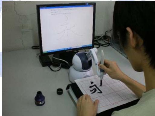
圖 4-2 操作者進行毛筆字書寫輔助系統的情形
