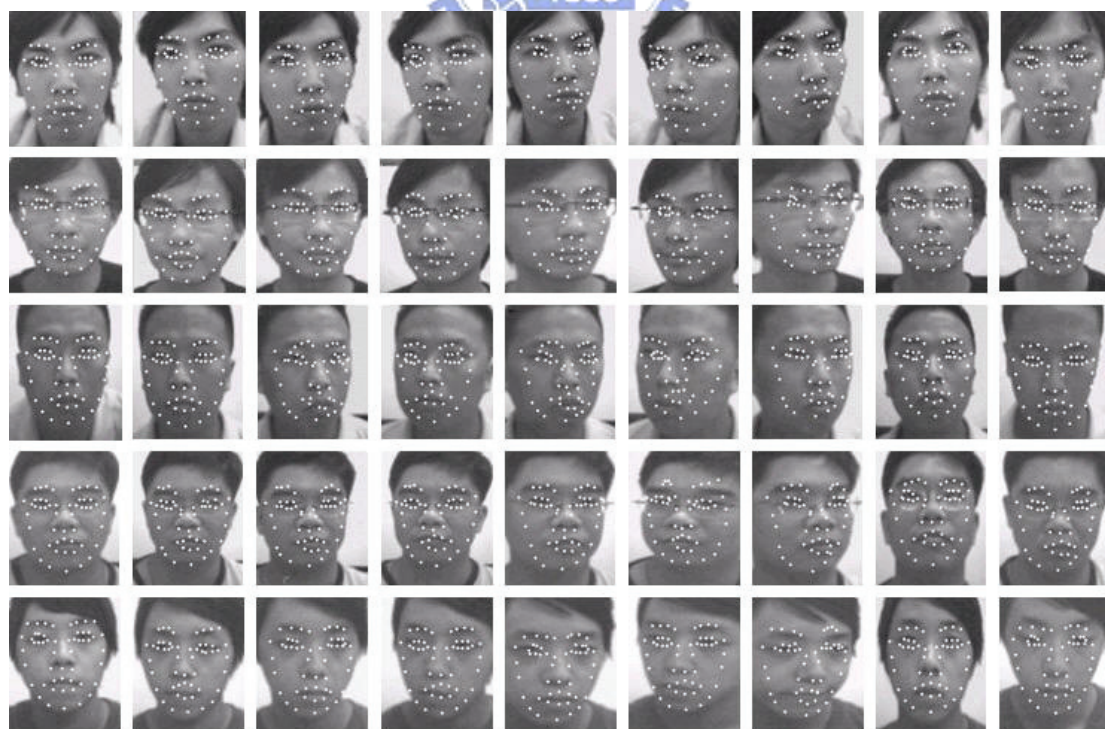
圖 5-4 實驗室資料庫之多姿態人臉經影像校正演算法迭代 15 次後結果
