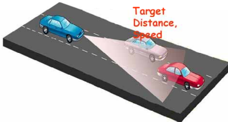
圖 1.2 防撞雷達功能示意圖
