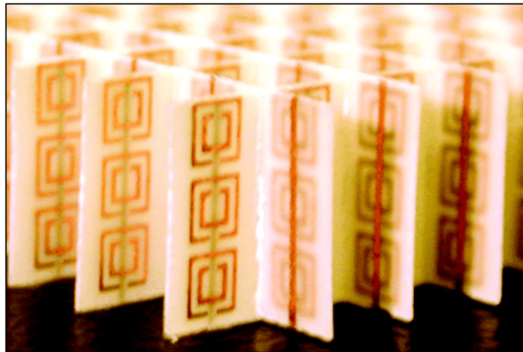
圖 2-4 實現左手材料的周期性結構 Split-ring resonators(SRRs)
