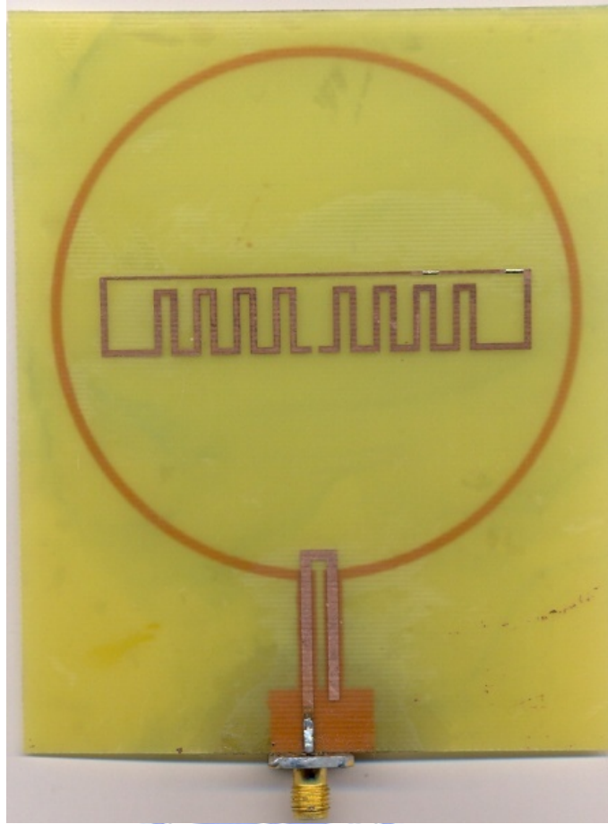
圖 5-40 整合平衡非平衡轉換器之等效縮小化印刷摺疊偶極天線實作照相圖
