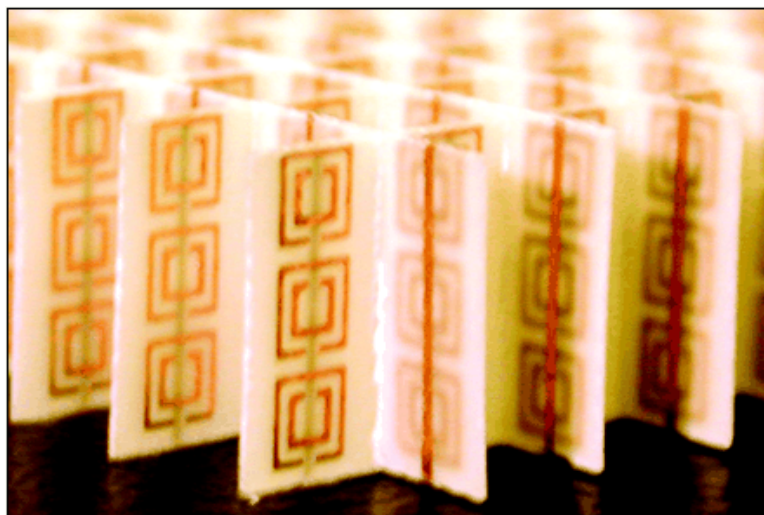
圖 2-3 左手材料的周期性結構(SRRs)[2]
