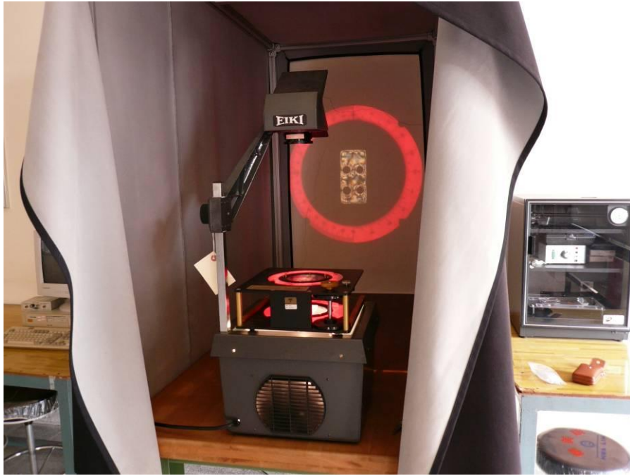
圖 4-10 光彈應力觀測設備
