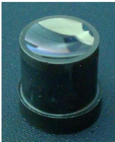
圖 4-7 無硬膜層 M78 模仁實驗後外觀圖
