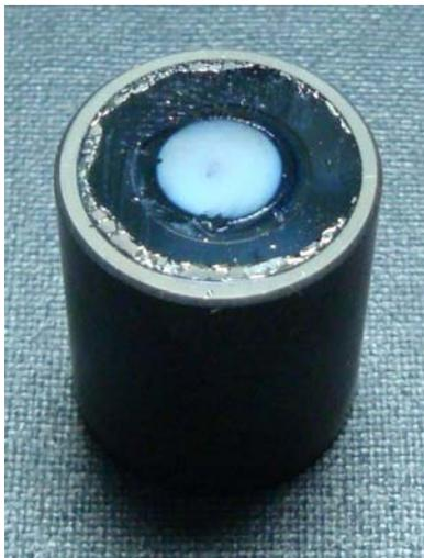
圖 4-3 TiAlN #2 硬膜層脫落情形
