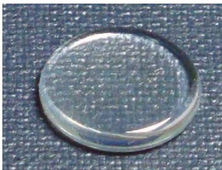
圖 4-8 無硬膜層 M78 模仁實驗透鏡成品圖
