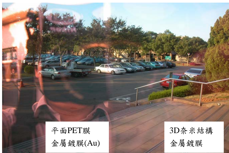
圖5.27 金屬(Au)薄膜試片外景實拍測試比較(膜厚25nm)
