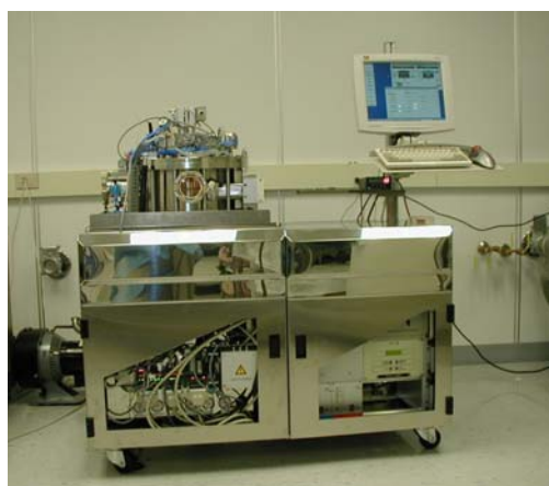
圖 4.2 奈米壓印機台
