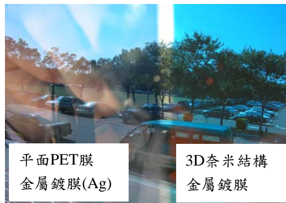
圖 5.31 金屬 (Ag) 薄膜試片外景實拍測試比較(膜厚 25nm)
