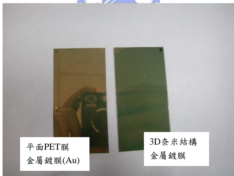
圖5.25 金屬(Au)薄膜試片外觀(膜厚25nm)
