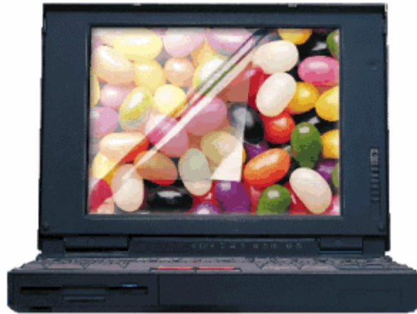
圖 1.2 抗反射膜(AR film)使用效果 (左上：無 AR，右下：有 AR)
