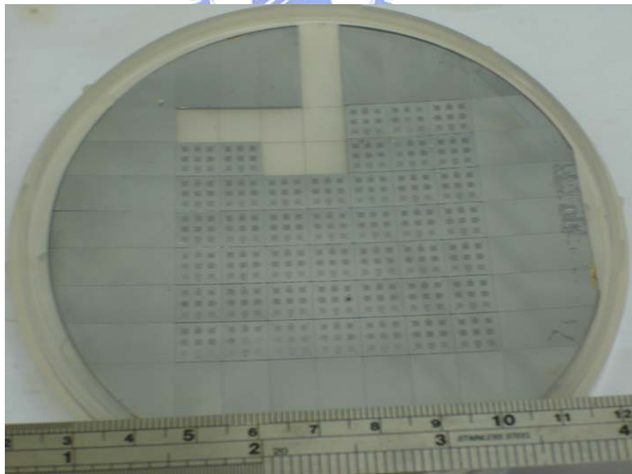
圖 3-8 四吋晶圓上的 10 \mu m 晶片
