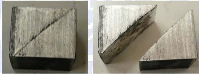
圖 4-5 180°C 下進行 CCDC 製程發生斷裂
