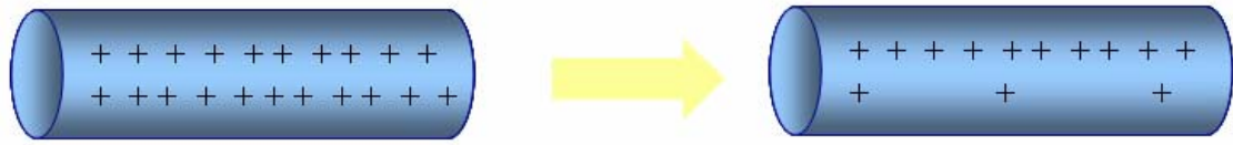
圖 2.7 黏彈性恢復力與庫倫靜電力之平衡示意圖
