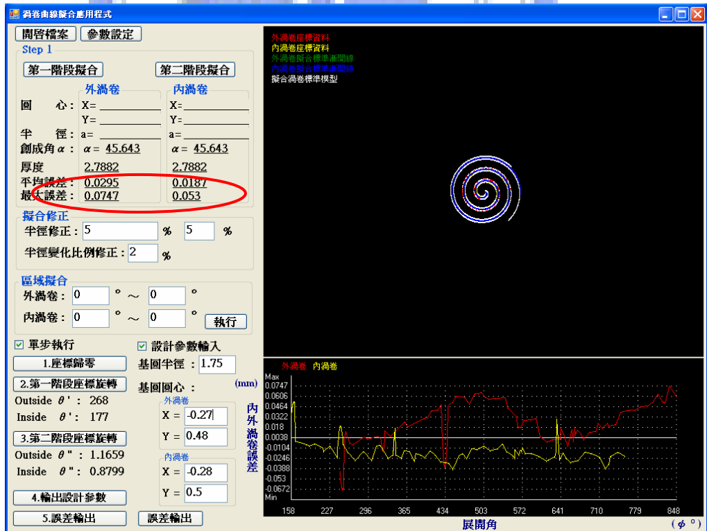
圖 4.16 已作硬體設備校正之之渦卷影像系統檢測誤差
