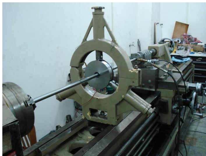
圖 4.11 MR damper 裝於 BTA 鑽床圖
