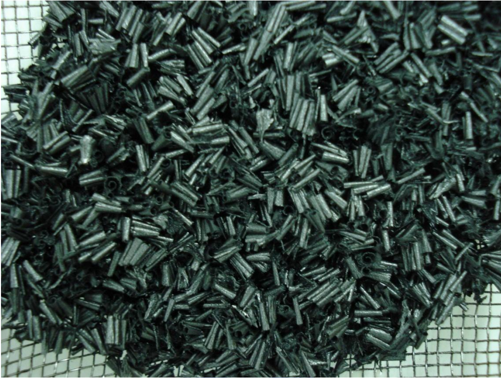
圖 5.17 田口式參數設計最佳化後的切屑
