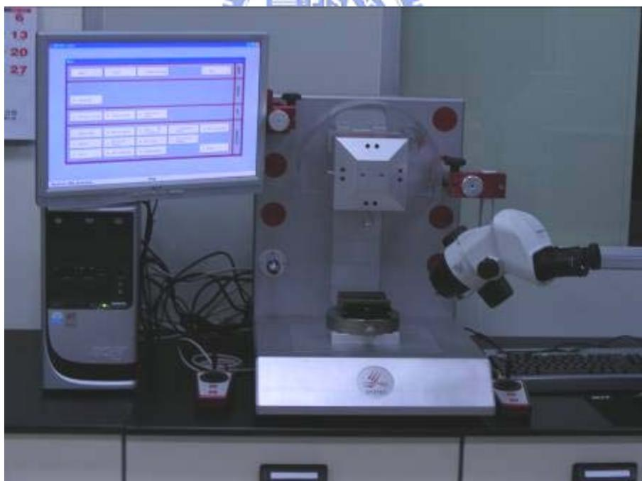
圖 3-6 微負荷拉伸試驗機
