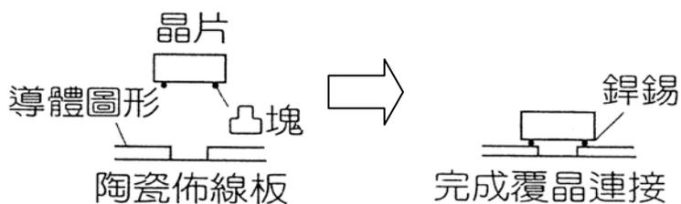
圖2-5 覆晶接合示意[6]
