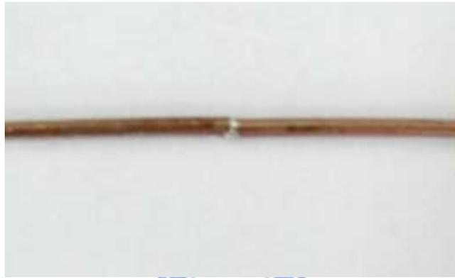
圖 3-3 Cu 基材試棒接合後之實體照片
