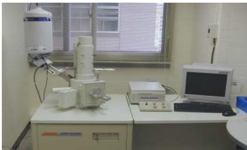
圖 3-5 掃描式電子顯微鏡設備
