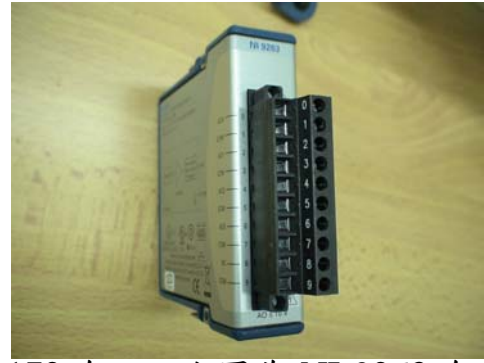
圖 19 DAQ 的類比輸出模組. 左圖為 NI-9172 介面，右圖為 NI-9263 介面。
