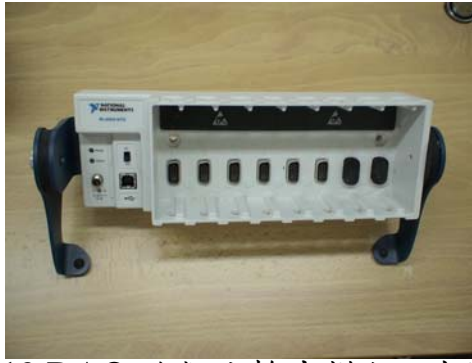
圖 19 DAQ 的類比輸出模組. 左圖為 NI-9172 介面，右圖為 NI-9263 介面。
