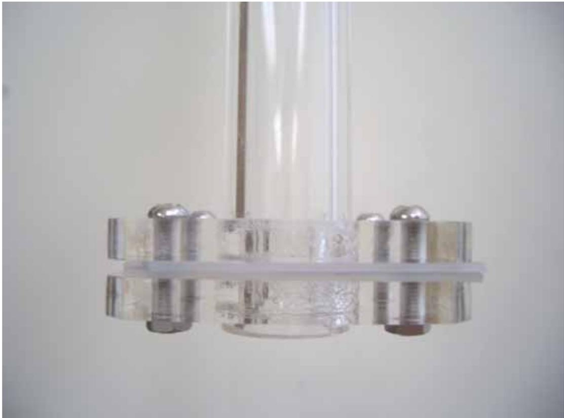
圖 10 透水系統(一)之測試段
